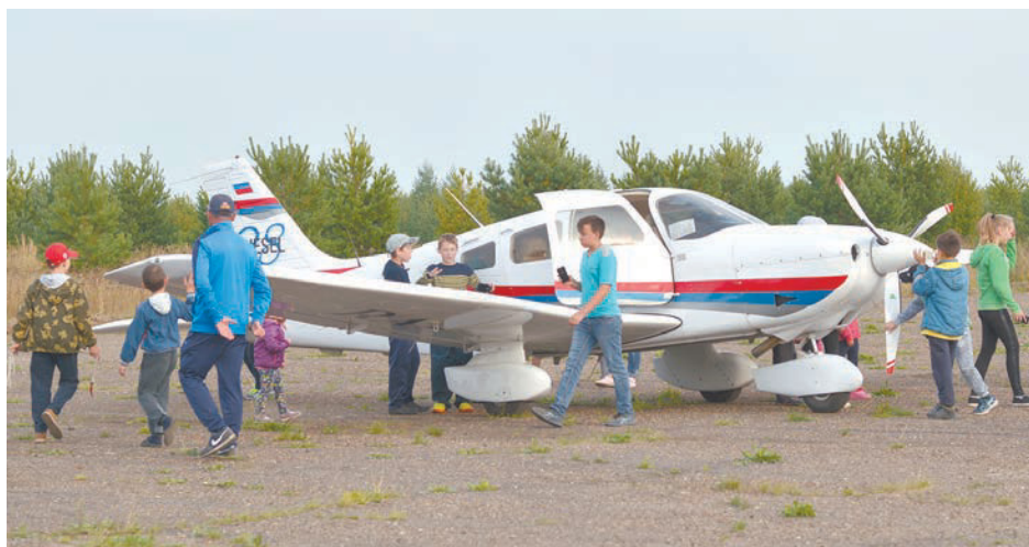
Piper PA 28 Archer DX – новая экономичная модель, которая может летать не только на авиакеросине, но и на дизельном топливе
