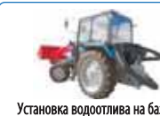
Установка водоотлива на базе МТЗ
